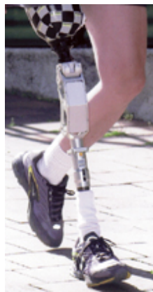
FIG. 5.20 – Une prothèse de jambe utilisant un amortisseur commandable.
